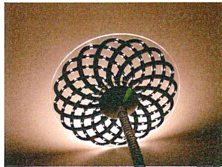
Abb.: Die Platine, die sich sehen lassen kann: Das Besondere der LED-Leuchten-Discs ist die transparente Platine aus Polycarbonat, in der die LEDs eingesetzt sind.
